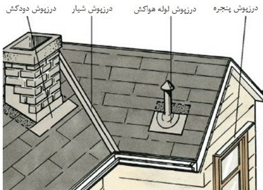
شکل ب-۱۱- درزپوش‌های فلزی ۱
